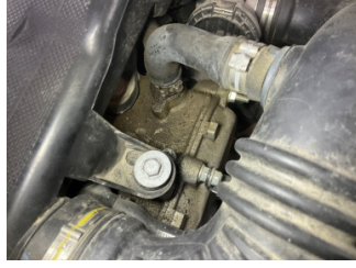
Motor, Motor üst kapağı, plastik > Yağ Kaçağı
