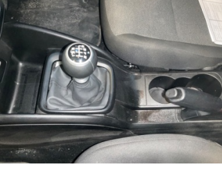
Şanzıman, Vites körüğü > Hasarlı
