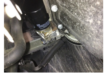
Motor, Yağ filtresi > Yağ Kaçağı
