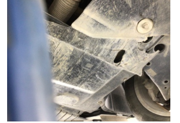
Motor, Alt muhafaza > Hasarlı
