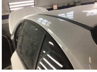
Tavan, Sol üst frangart > Dolu Hasarı
