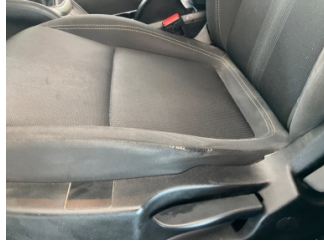
Koltuklar, ön, Koltuk, sol ön > Deforme Olmuş
