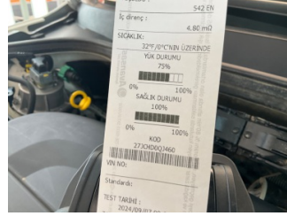
Elektrik donanımı/Pano, Akü > Test Sonucu
