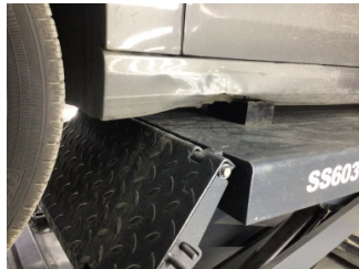
Marşbiyel, sol, Marşbiyel, sol > Hasarlı
