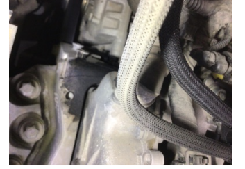
Motor, Triger zinciri kapağı > Yağ Kaçağı
