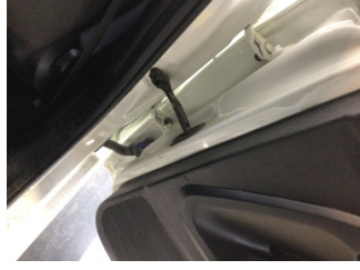
Kapı, sağ arka, Kapı gergisi > Ses Yapıyor
