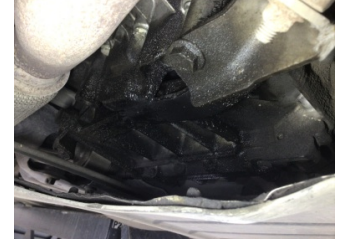
Şanzıman, Şanzıman > Yağ Kaçağı
