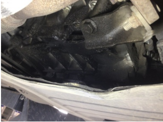
Şanzıman, Şanzıman > Yağ Kaçağı
