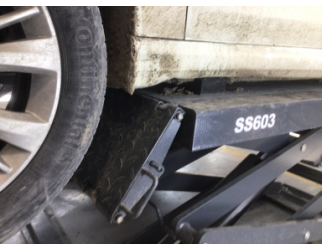
Marşbiyel, sol, Marşbiyel, sol > Hasarlı
