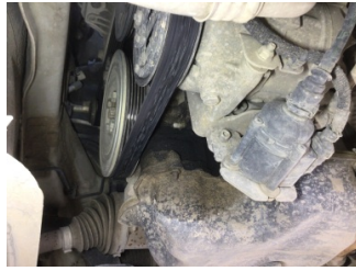
Motor, Triger zinciri kapağı > Yağ Kaçağı
