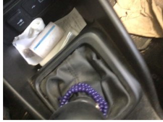
Şanzıman, Vites körüğü > Deforme Olmuş
