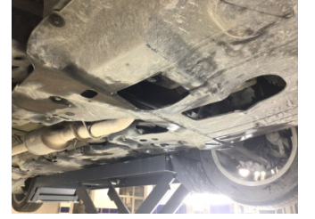
Motor, Alt muhafaza > Hasarlı
