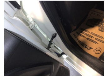
Kapı, sol arka, Kapı gergisi > Ses Yapıyor
