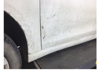
Kapı, sağ ön, Kapı, sağ ön > Boyası Atmış
