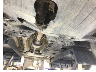
Motor, Alt muhafaza > Hasarlı
