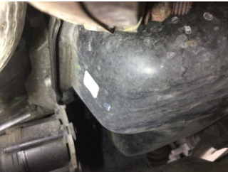
Motor, Triger zinciri kapağı > Yağ Kaçağı
