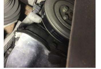
Motor, Triger zinciri kapağı > Yağ Kaçağı
