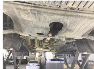
Motor, Alt muhafaza > Hasarlı
