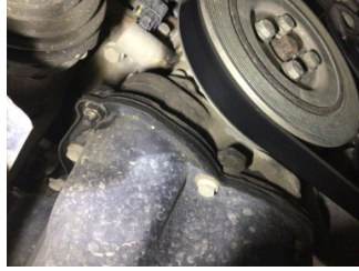
Motor, Yağ karteri contası > Yağ Kaçağı
