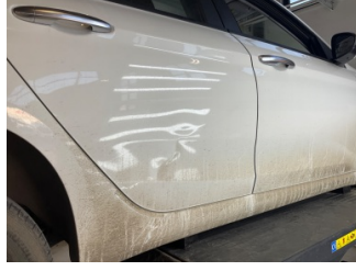
Kapı, sağ arka, Kapı, sağ arka > Hasarlı
