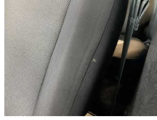
Koltuklar, ön, Koltuk döşemesi, sol ön > Yakıcı Madde ile Zarar Görmüş
