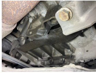
Motor, Triger zinciri kapağı > Yağ Kaçağı
