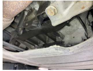
Motor, Triger zinciri kapağı > Yağ Kaçağı
