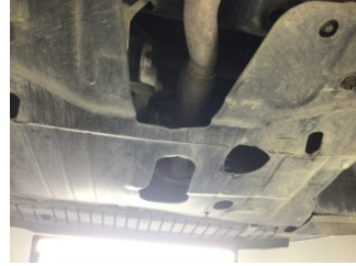
Motor, Alt muhafaza > Hasarlı
