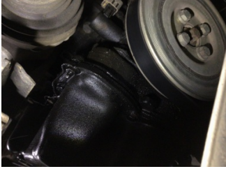
Motor, Yağ karteri > Yağ Kaçağı
