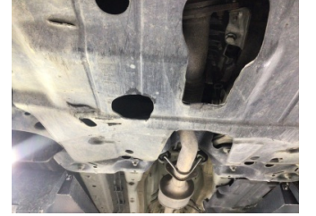
Motor, Alt muhafaza > Hasarlı
