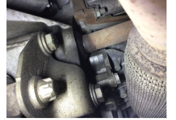
Ön aks, Aks mili, sağ > Yağ Kaçağı
