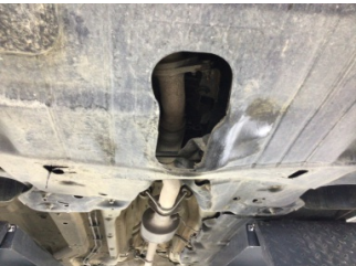
Motor, Alt muhafaza > Hasarlı
