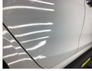
Kapı, sağ arka, Kapı, sağ arka > Ezik
