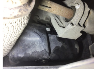
Motor, Yağ karteri contası > Yağ Kaçağı
