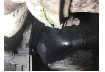
Motor, Yağ karteri contası > Yağ Kaçağı
