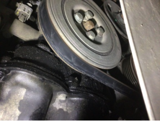
Motor, Triger zinciri kapağı > Yağ Kaçağı
