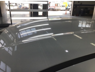
Tavan, Tavan > Dolu Hasarı
