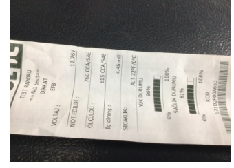
Elektrik donanımı/Pano, Akü > Test Sonucu
