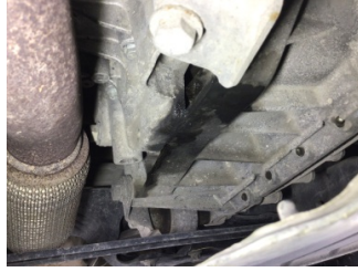
Şanzıman, Şanzıman > Yağ Kaçağı
