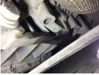
Şanzıman, Şanzıman > Yağ Kaçağı
