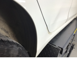
Çamurluk, sağ arka, Çamurluk, sağ arka > Ezik
