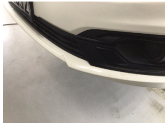
Tampon, ön, Ön tampon ızgarası > Boyası Atmış
