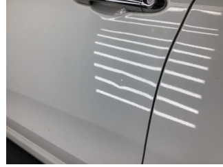
Kapı, sol ön, Kapı, sol ön > Noktasal Ezik
