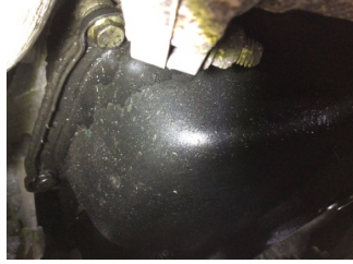
Motor, Yağ karteri > Yağ Kaçağı
