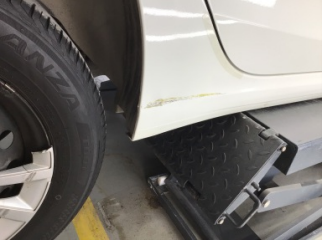
Marşbiyel, sağ, Marşbiyel, sağ > Hasarlı
