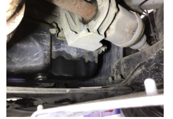
Motor, Yağ karteri > Yağ Kaçağı
