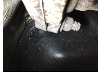
Motor, Yağ karteri > Yağ Kaçağı
