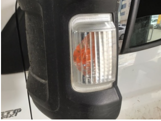
Dikiz aynası, sol, Sinyal lambası > Çatlak
