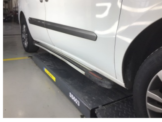
Marşbiyel, sağ, Sabitleme > Hasarlı
