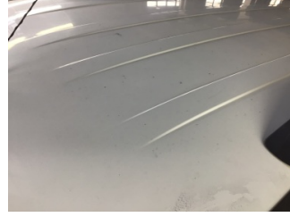
Tavan, Tavan > Dolu Hasarı
