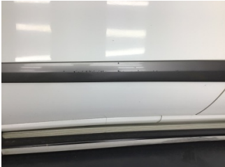
Kapı, sol ön, Kapı bandı > Çizik
