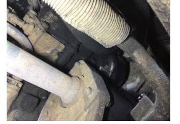
Motor, Yağ soğutucusu > Yağ Kaçağı
