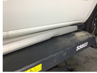
Marşbiyel, sağ, Sabitleme > Hasarlı
