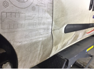
Kapı, sağ arka, Kapı, sağ arka > Ezik
