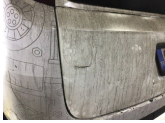
Bagaj kapağı/kapısı, Arka spoyler > Hasarlı
