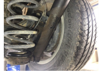
Arka aks, Amortisör, arka sağ > Deforme Olmuş
