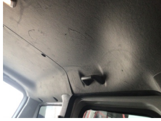
Döşemeler/Kapaklar, Tavan döşemesi > Deforme Olmuş
