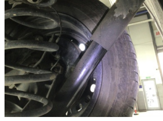
Arka aks, Amortisör, arka sağ > Yağ Kaçağı
