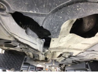
Motor, Alt muhafaza > Hasarlı
