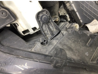
Farlar, Far, sol > Hasarlı
