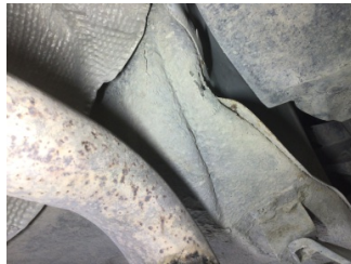
Arka bölüm, İstepne yuvası > Hasarlı
