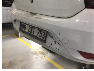
Tampon, arka, Arka tampon > Boyası Atmış
