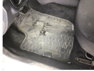
Taban, Taban halısı > Deforme Olmuş
