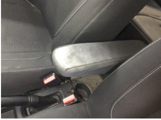
Döşemeler/Kapaklar, Kol dayaması, ön > Deforme Olmuş
