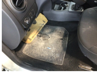
Taban, Paspaslar > Deforme Olmuş
