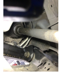
Ön aks, Aks mili, sol > Yağ Kaçağı
