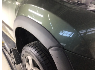
Çamurluk, sağ, Çamurluk ağız > Standart Dışı Onarım
