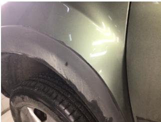
Çamurluk, sol, Çamurluk ağız > Standart Dışı Onarım
