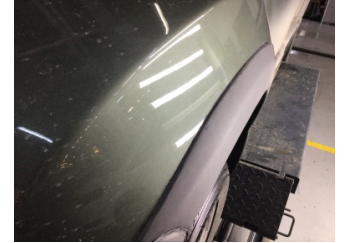
Çamurluk, sol, Çamurluk ağız > Standart Dışı Onarım
