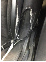
Koltuklar, ön, Koltuk, sol ön > Deforme Olmuş
