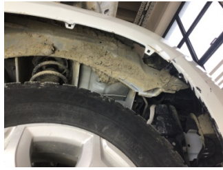
Motor, Alt muhafaza > Hasarlı
