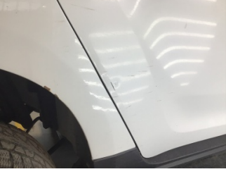
Kapı, sağ arka, Kapı, sağ arka > Ezik
