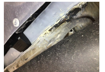
Arka bölüm, Bagaj havuzu > Hasarlı
