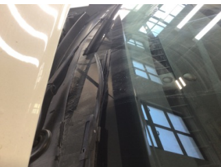
Cam yıkama/silme sistemi, Silecek sol > Deforme Olmuş
