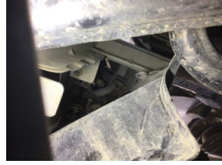
Çamurluk, sağ, Bağlantı ayağı > Hasarlı
