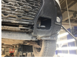
Tampon, ön, Çeki demir kapağı > Sökülmüş-Yok
