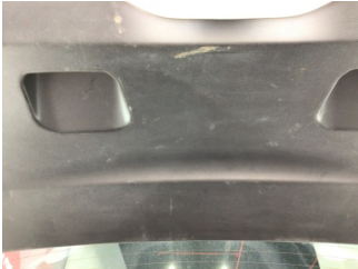
Döşemeler/Kapaklar, Döşemeler/Kapaklar > Çizik
