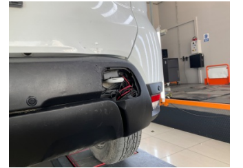
Tampon, arka, Çeki demir kapağı > Sökülmüş-Yok
