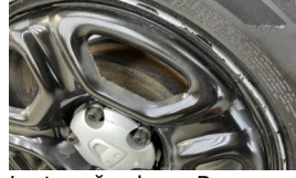
Jant, sağ arka > Boyası Atmış
