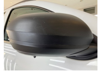
Dikiz aynası, sağ, Dış dikiz aynası kapağı > Yüzeysel Çizik
