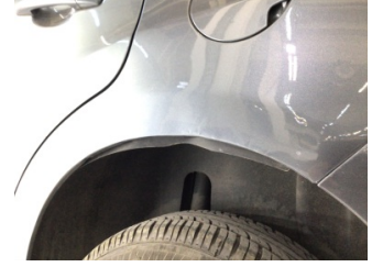
Çamurluk, sol arka, Çamurluk, sol arka > Boyası Atmış
