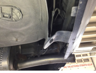
Tampon, arka, Bağlantı ayağı > Ezik
