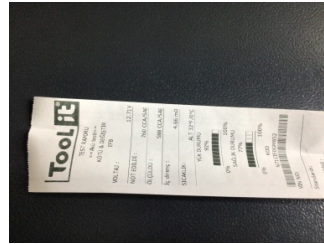
Elektrik donanımı/Pano, Akü > Test Sonucu
