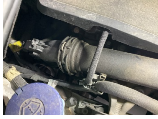
Motor, Turbo hortumları > Yağ Kaçağı
