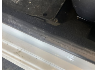
Kapı, sol ön, Kapı fitili > Hasarlı
