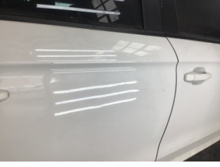
Kapı, sağ arka, Kapı, sağ arka > Ezik
