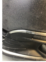
Tampon, ön, Ön tampon ızgarası > Çatlak
