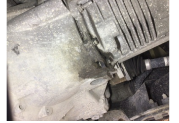
Şanzıman, Şanzıman > Yağ Kaçağı
