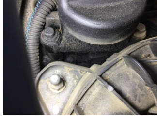
Motor, Motor üst kapağı, plastik > Yağ Kaçığı
