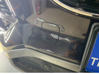
Tampon, ön, Çeki demir kapağı > Boyası Atmış
