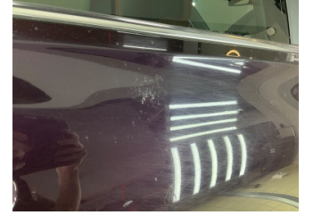
Kapı, sağ arka, Kapı, sağ arka > Yakıcı Madde İle Zarar Görmüş
